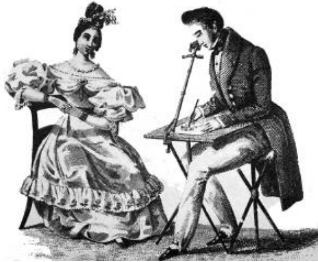
Görsel 3: Yaklaşık 1830'da kullanımdaki Camera Lucidanın gravürü.
