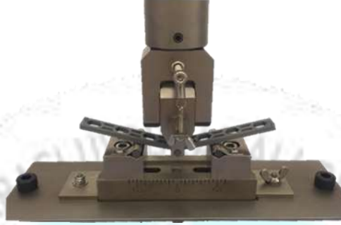
Görsel 3. Üç Boyutlu Baskı İle Üretilen Numunelerin Shimadzu AG-X Test Cihazındaki Yerleşimi
