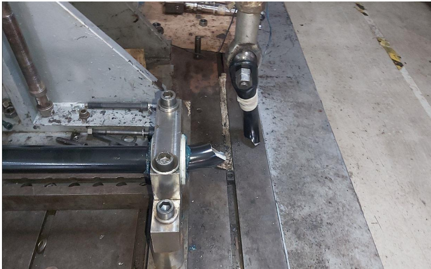
Görsel 7. Yorma testinde kırılan çubuk.
