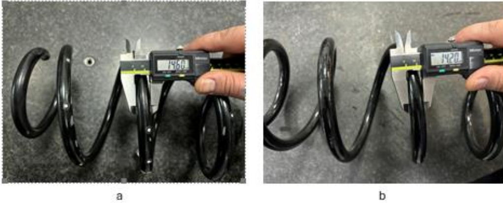
Görsel 21. Helisel yayların tel çap ölçümleri.
