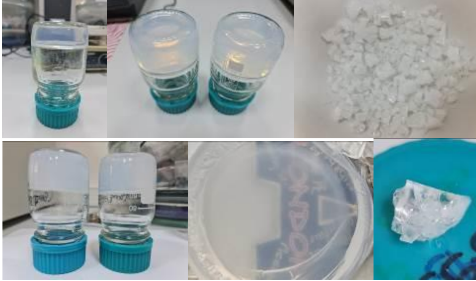
Görsel 1. Proje kapsamında hazırlanan BaO-içeren 13-93 biyoaktif cam tozlarının sentezine ait gösteren fotoğraflar; üst satır Ba(NO 3 ) 2 alt satır BaCl 2 .2H 2 O kullanılarak hazırlanmıştır.
