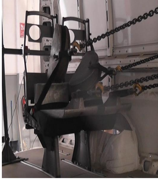
Şekil 8. Hafifletilmiş ve güçlendirilmiş koltuğun test sonrası durumu
