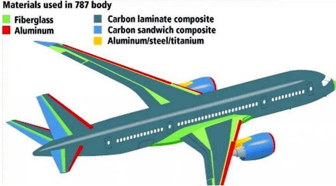
Görsel 1. Boeing 787 Uçak gövde yapısında kullanılan malzemeler [2]
