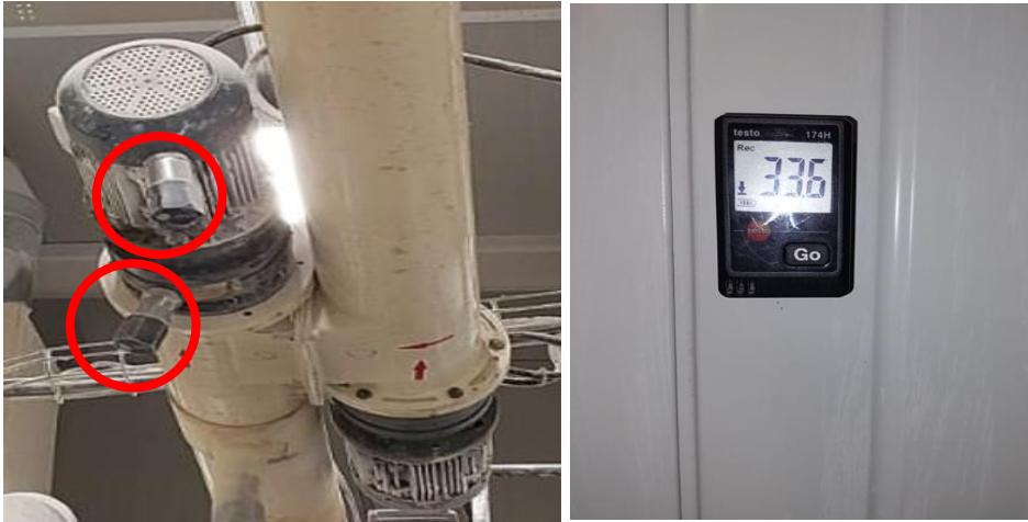
Görsel 2. Sıcaklık/titreşim ölçer sensörlerin ve datalogger görünümü
