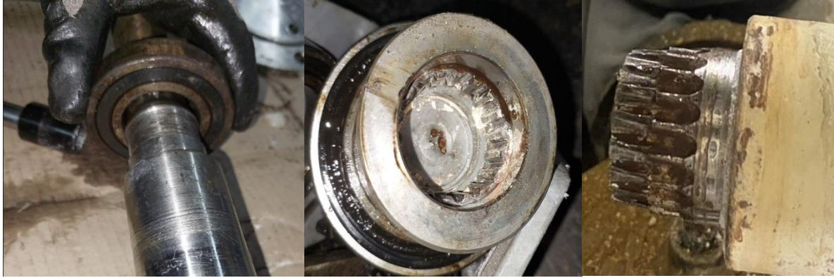
Görsel 12. Uzun duruşlara (Class 3) neden olan dişli ve mil arıza görselleri
