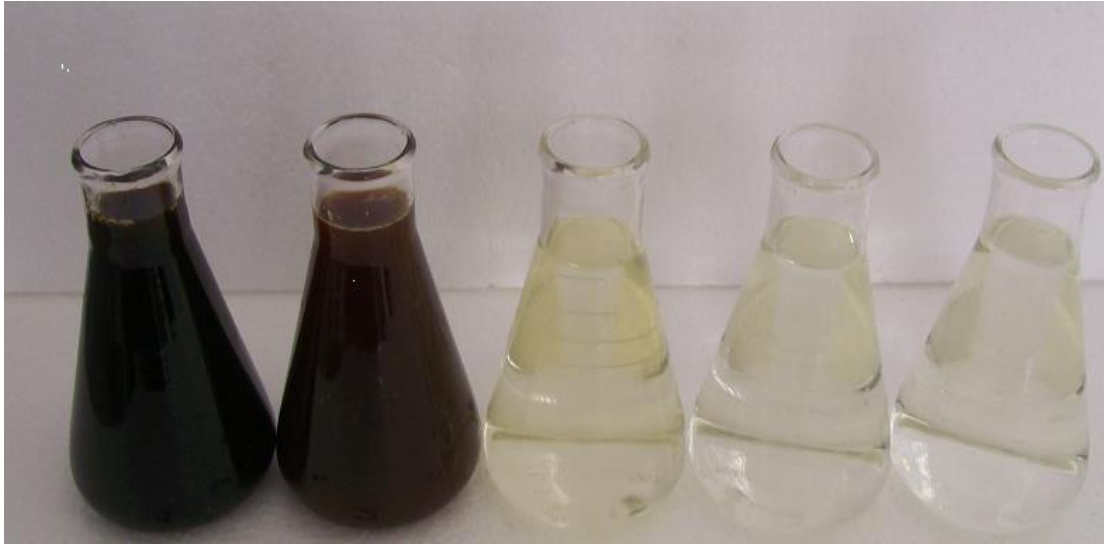
Kireç/şap Kireç/şap/ NaBO 3 .H 2 O.3H 2 O O 3 /NaBO 3 .H 2 O. 3H 2 O O 3 /UV/ NaBO 3 .H 2 O.3H 2 O O 3 /UV/ (O 3 =1,5g dak -1 ) NaBO 3 .H 2 O.3H 2 O (O 3 =3.0g dak -1 )
