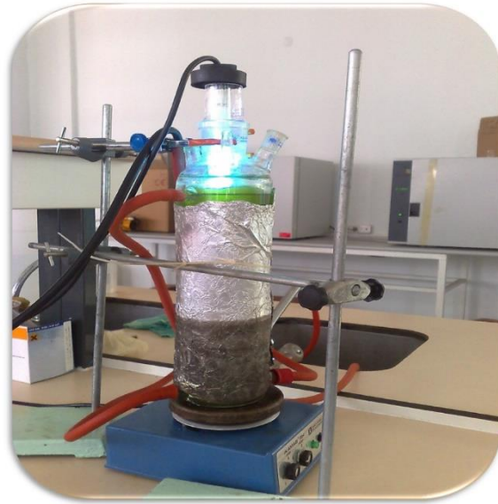
Görsel 1. Deneysel çalışmada kullanılan UV reaktörünün şematik (a) ve deney düzeneğine ait görüntü
