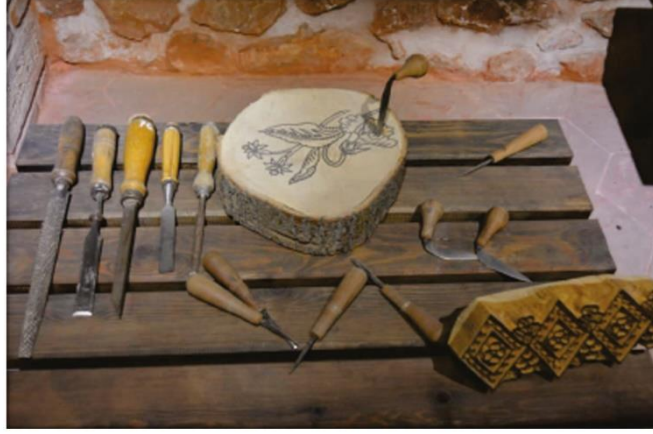
Görsel 10. Tokat Yazmacılığında Oyma Aletleri ve Kalıplar.
