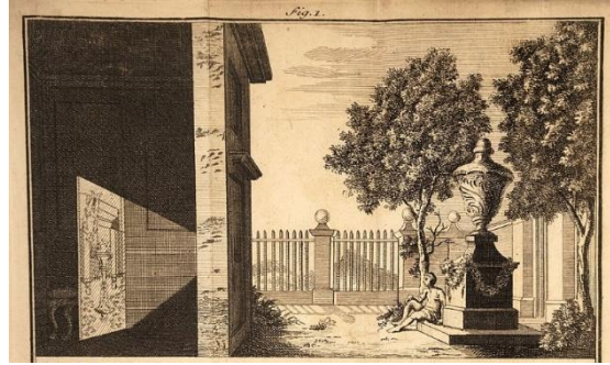
Görsel 1: James Ayscough'un Göz ve Görmenin Doğası Üzerine Kısa Bir Hesap (1755 dördüncü basım) adlı eserinden Camera Obscura ilkesinin çizimi
