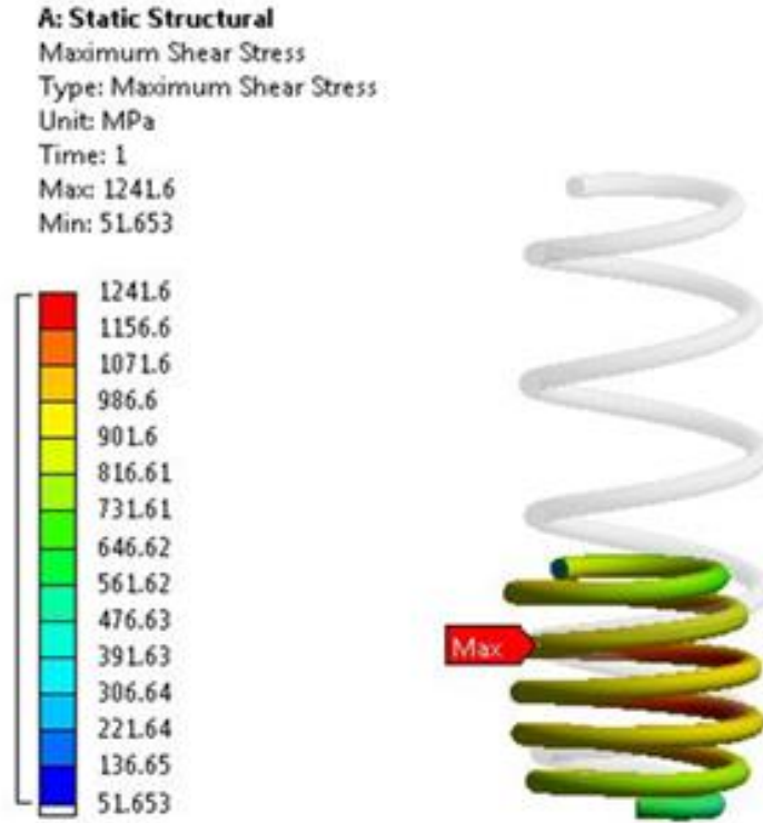
Görsel 18. Sonlu elemanlar yöntemi ile yapılan stres analizi.
