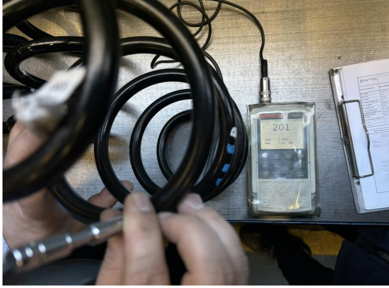
Görsel 20. Boya kalınlık ölçümü görülmektedir.
