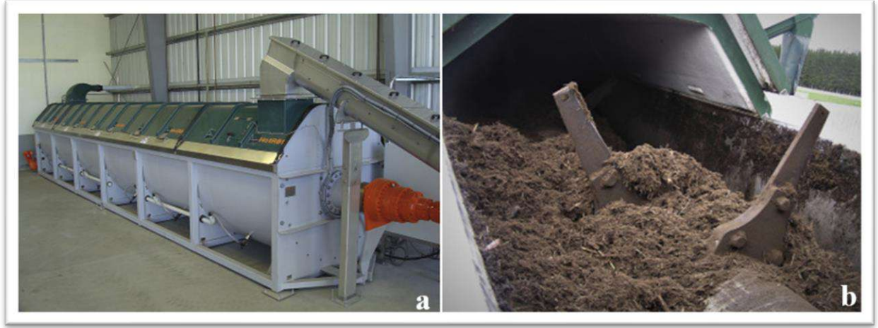
Şekil 11. Tam kontrollü, içten karıştırımalı kompost bioreaktörü (Michel vd., 2022)
