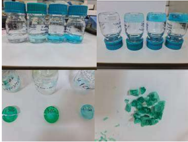
Görsel 1. Proje kapsamında hazırlanan CuO-içeren 13-93 biyoaktif cam tozlarının sentez aşamalarını gösteren fotoğraflar.
