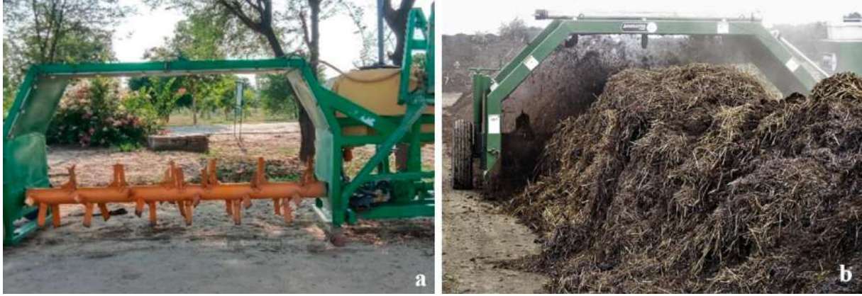
Şekil 7. Kompost aktarma ve karıştırma makinası (a) (Hashim vd., 2024), kompost karıştırılması (b) (Oshins vd., 2022)
