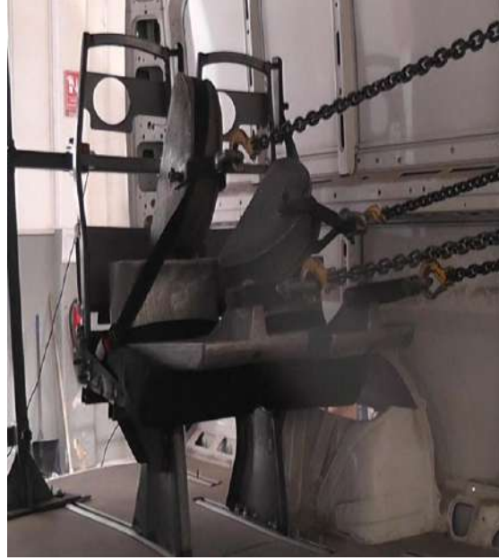
Şekil 8. Hafifletilmiş ve güçlendirilmiş koltuğun test sonrası durumu
