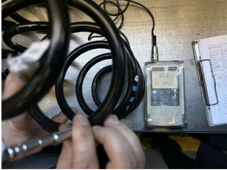
Görsel 20. Boya kalınlık ölçümü görülmektedir.
