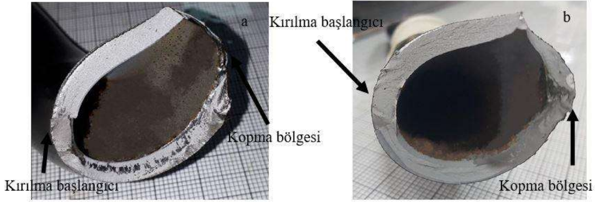
Görsel 10. a) 62402 çevrimde kırılan çubuk, b) 70254 çevrimde kırılan çubuk.
