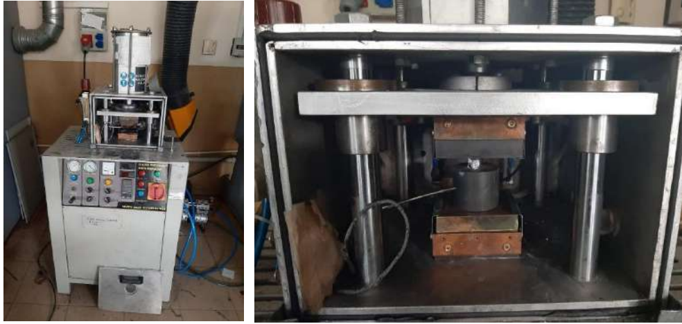
Görsel 8. Tugem marka HP15 3000 sıcak pres cihazı ve numune yerleşimi
