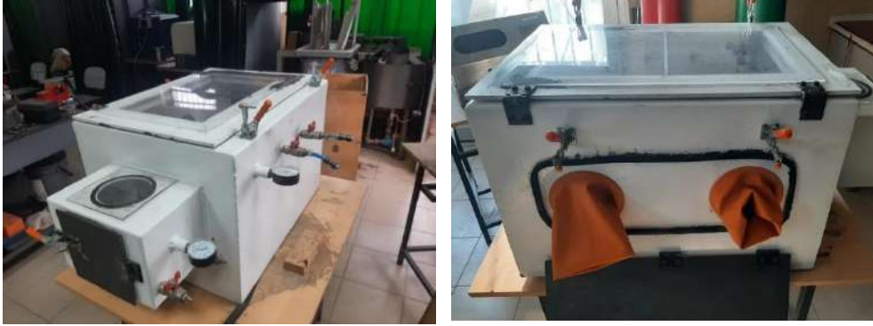
Görsel 6. Atmosfer (argon) Ortamı için Kullanılan Glove – Box
