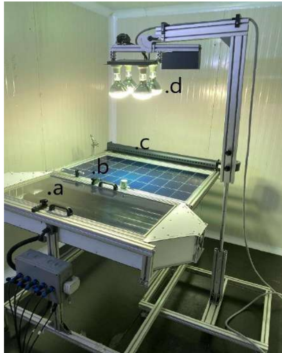
Görsel 3. Güneş paneli performans test odasının iç görünümü ve deney düzeneği
