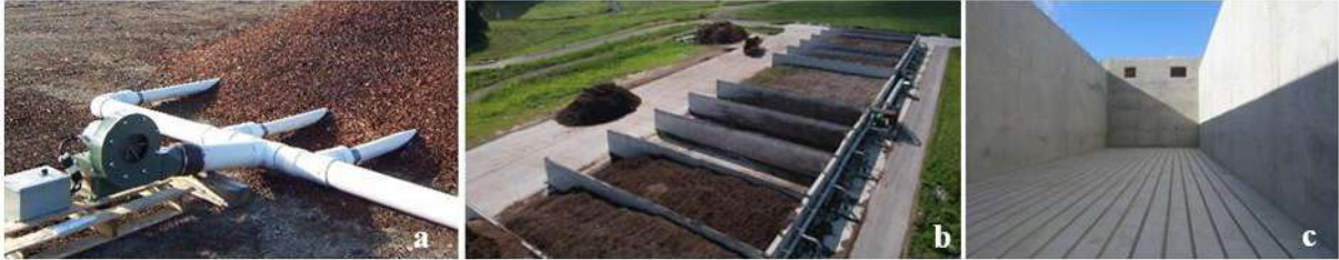
Şekil 9. Havalandırmalı statik yığın kompostlama sisteminde açık (a) (Anonim 2024b), yarı açık (b) (Anonim 2024c) ve yarı açık bunker sistemi (c) (Anonim 2024d).
