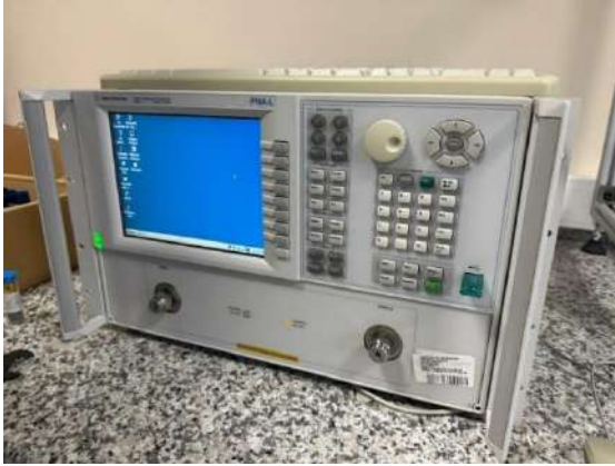
Görsel 13. Agilent Technologies marka PNA-L – N5230C modelindeki vektör network analiz cihazı ve numune yerleştirilmesi
